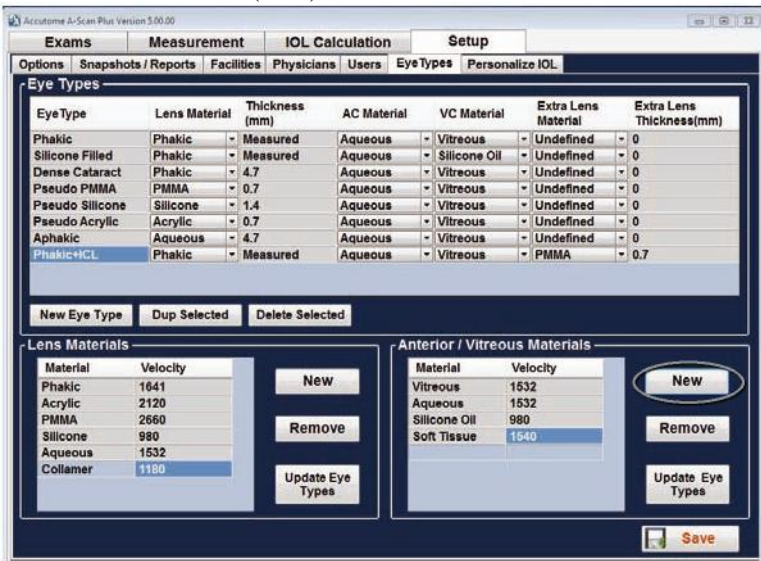
Figura 5-46 Finestra Nuovo materiale camera anteriore/vitrea attivata
